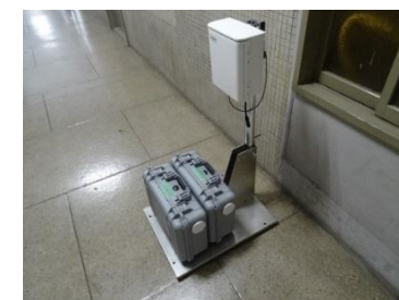
可搬型モニタリングポスト(例) [バッテリー付]
