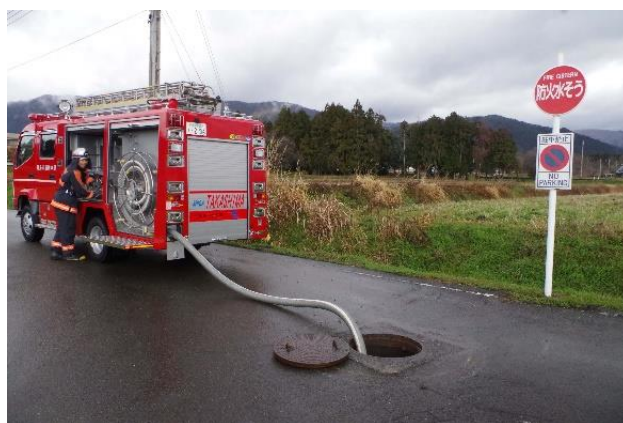
防火水そう使用状況
