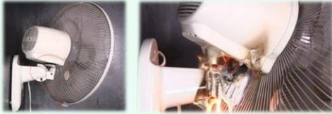
長期間使用された扇風機の首振り部の内部配線が断線し、スパークが発生し出火。
