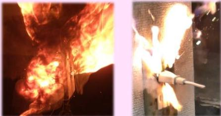
コンセントとプラグの間に付着した埃や湿気により、火花放電を繰り返し、電気回路が形成され出火。
