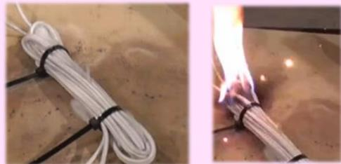
束ねた電気コードや、タコ足配線等により許容電流以上の電流が流れることで、発熱し出火。
