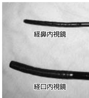
今回導入される内視鏡は、超小型CCDカメラを採用したスコープで先端部外径が5・0mm、挿入部外径が5・5mmと従来の経口内視鏡に比べて非常に細くなっています。
