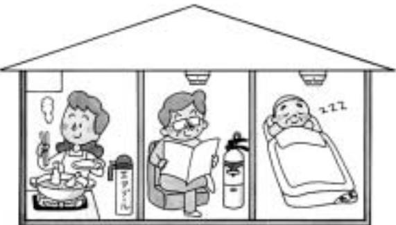
火災警報器は、火災による煙、または熱を感じて警報音、音声で知らせてくれる機器で、火災の早期発見に大変有効です。
