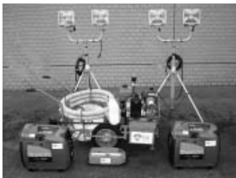
D-1級軽可搬消防ポンプ1台、発電機2台、投光器2台
