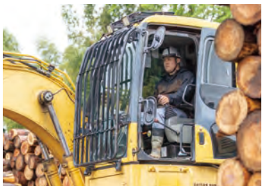
作業道の開設では重機で不要な木を取り除く。必要以上に除去すると、土砂崩れや水害を招きやすいため繊細な作業が求められる。
