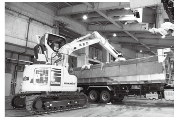
②重機で荷台のごみをならす
