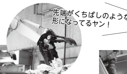
①ごみクレーンでごみを積み替える(一掴みで約1t)
